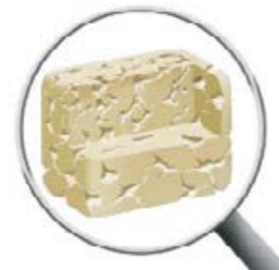
شكل تخطيطي يظهر شبكة الخزف السائدة في مادة Vita Enamic
