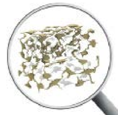
يمثل الشكل شبكة البوليمير التي يتسرب في شبكة الخزف
